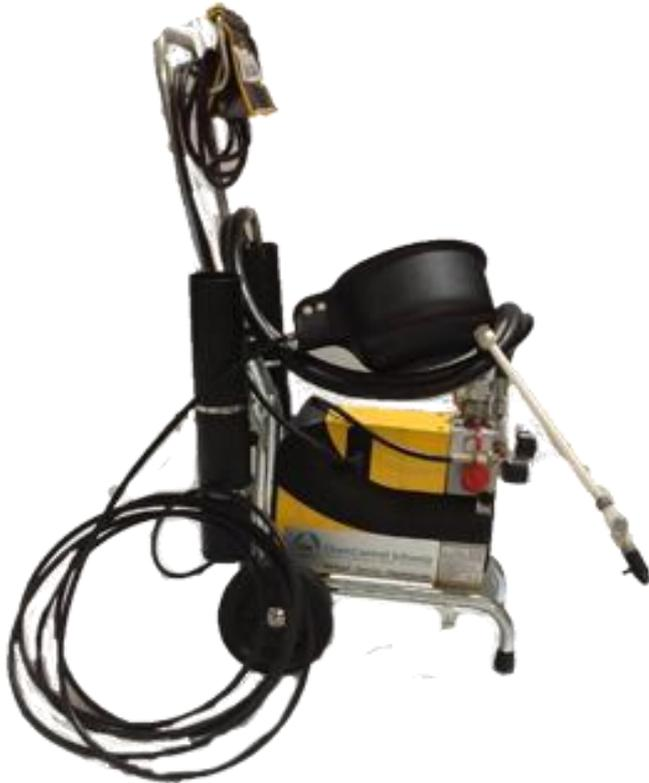
**Descrizione:** Elettropompa ad alta pressione, Airless System. Per il corretto utilizzo, è stata **integrata in alcune sue parti**
